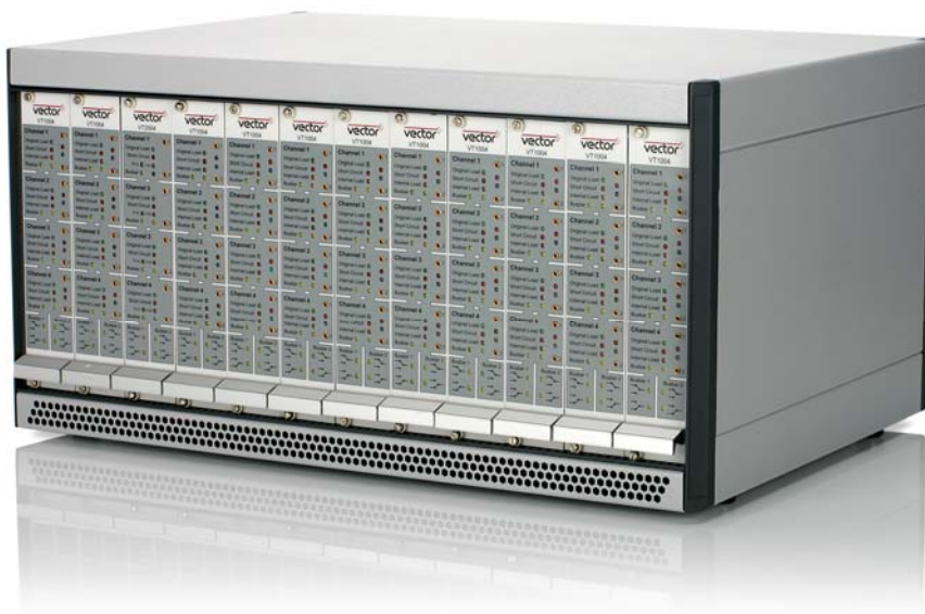
Komplett bestücktes Rack des VT Systems – bis zu 12 Module und eine Backplane passen in ein 19“-Gehäuse
